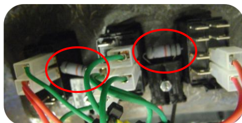
1 resistor de 220 OHMS entre cada botão
